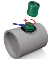
TWISTEE-Stutzen eindrehen, festziehen und Überschiebmuffe aufschieben.
