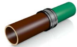
Kupplung mittig über beide Spitzenden schieben und Schlösser wechselseitig anziehen.
