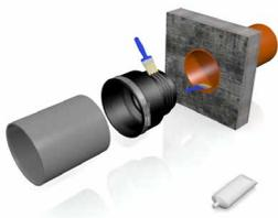
Gleitmittel auf das Steckende des Steckadapters und der Rohrinnenwand auftragen.
