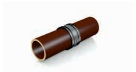
Kupplung mittig über beide Spitzenden schieben und Schlösser wechselseitig anziehen.
