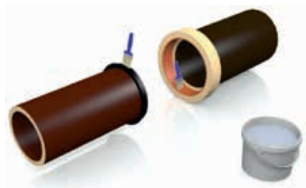
Gleitmittel MGM auf Muffe und Spitzende auftragen.
