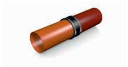
Kupplung mittig über beide Spitzenden schieben und Schösser wechselseitig anziehen.
