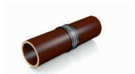
Kupplung mittig über beide Spitzenden schieben und Schlösser wechselseitig anziehen.
