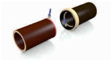
Gleitmittel auf Spitzendichtung und in Muffe auftragen.
