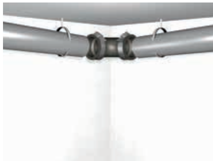
Flexiblen Bogen zwischen Spitzenden positionieren.
