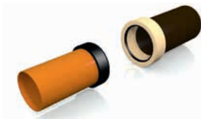
Übergangsring (Ü-Ring) auf Spitze aufziehen.
