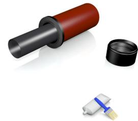
Gummiadapter in größeres Rohr einsetzen, Gleitmittel auf Rohrspitze auftragen und kleineres Rohr einschieben.
