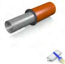
Kleineres Rohr in den Gummiadapter schieben.
