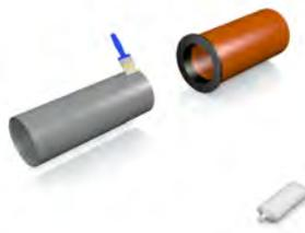
Gummiadapter in größeres Rohr schieben.
