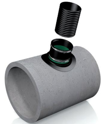
Kupplung aufschieben und Schloss anziehen. Rollring im zweiten Wellental vom AquaFlex/AquaTub-Rohr einlegen. Rohr einschieben und weiteres Schloss anziehen.
